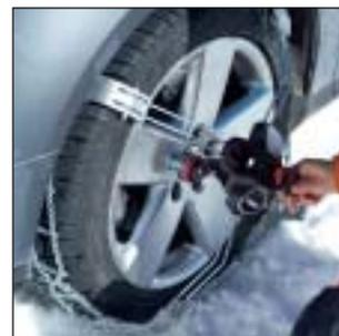
3. Betätigen Sie das Ratschensystem. Fertig!
