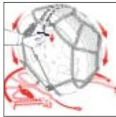
Ziehen Sie einfach am roten Hebel und die Kette öffnet sich!
