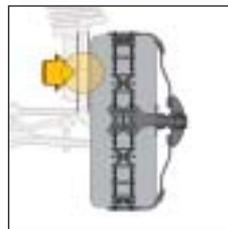
K-Summit ist die perfekte Lösung für Fahrzeuge mit wenig Freiraum hinter dem Reifen.
