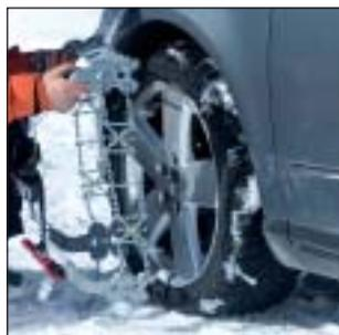
1. Legen Sie zwei der Kunststoff-Traktionsplatten auf die Rad-Lauffläche.
