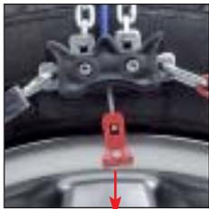
Einzigartiges und patentiertes, externes Schnell-Löse-System mit Einhandbedienung.
