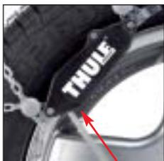
Patentiertes Selbstzentrierungs- und Selbstspannungssystem mit Mikroregulierung.
